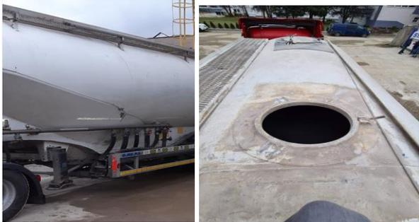
**Photo de la scène montrant le couvercle manquant - 2 des 3 mécanismes de fixation ont été cisailés lors de la libération de la pression.**
