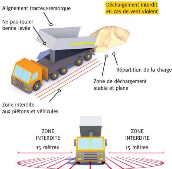
**Déchargement interdit si vent > à 40 – 50 km/h**
