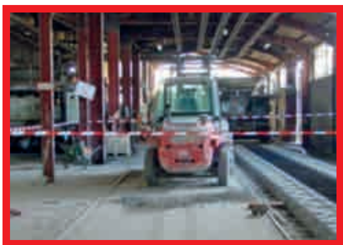
Accident mortel au sein du groupe – étude de cas 2009 : salarié heurté et tué par un chariot élévateur à fourche effectuant une marche arrière.
