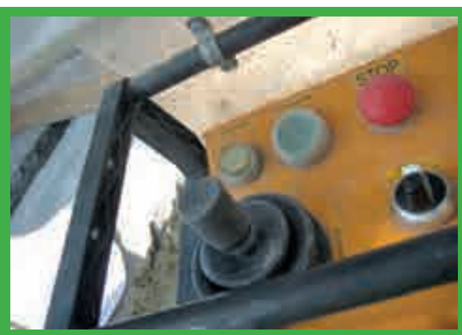
Joystick « homme mort ». Vous devez appuyer pour activer le joystick.
