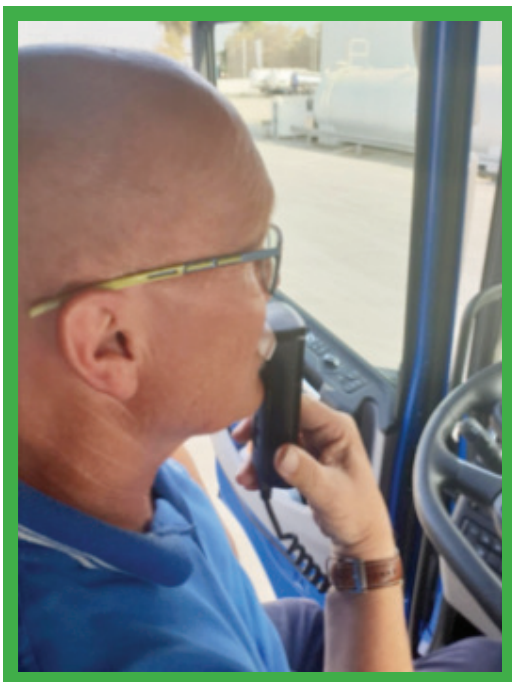
Un éthylotest antidémarrage installé directement sur le circuit électrique de démarrage du camion – Seul un test négatif autorise le démarrage du camion.
