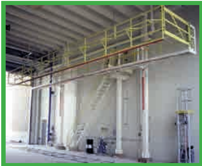
Sur le site de Finnsementti, système de protection du chauffeur de camion-citerne pendant le chargement. Ce système a été ajusté en longueur et en hauteur pour couvrir toutes les tailles de véhicules.
