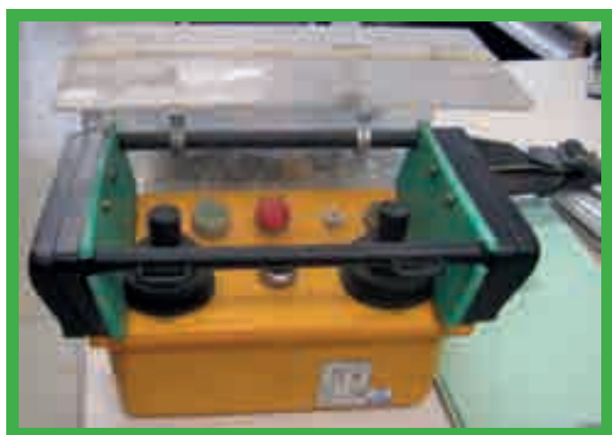
Joystick « homme mort ». Vous devez appuyer pour activer le joystick.
