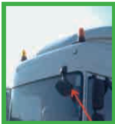
Rétroviseur de sécurité des piétons, une exigence CRH.
