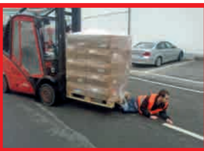
Reconstitution d'un accident grave – mars 2015 : le travailleur a été heurté par un chariot élévateur à fourche qui avançait. La vue du chauffeur était en partie bloquée par la charge.
