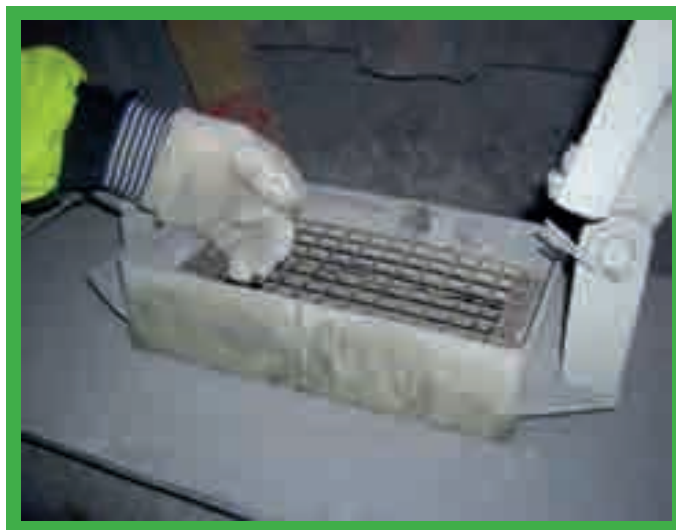
Trappe d'inspection (avec grille verrouillée) sur un transporteur à vis sans fin.
