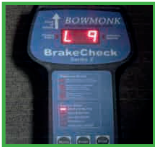
Testeur de frein pour grands véhicules de chantier.
