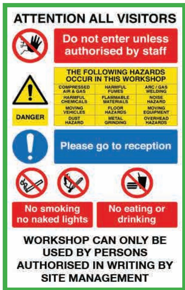
Une pancarte de ce type, conforme à la législation locale, doit être placée à l'extérieur des ateliers ou des zones d'entretien de véhicules du site.
