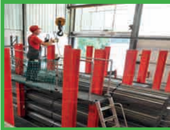
Accès sûr pour la fixation de crochets de levage.
